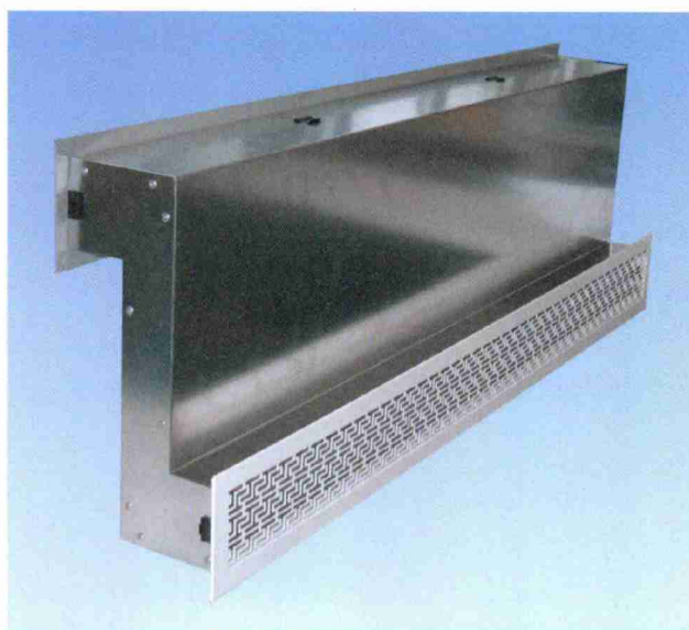
Prinzipiell schliessen aktive Überströmer isoliert gelegene Räume an ein bestehendes Lüftungssystem an. In der Regel fungiert ein Korridor als Zu- und Abluftbereich, an den einzelne Räume mittels Überströmlüfter angebunden werden. (Quelle OeJ)
