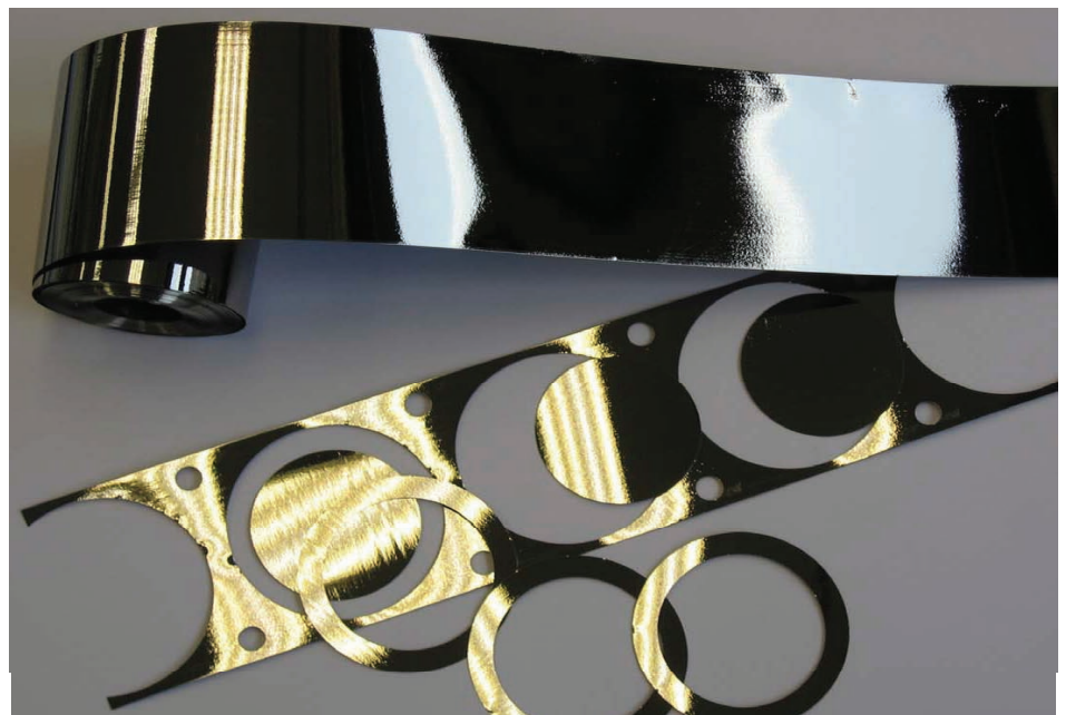
Metallische Gläser der Universität Basel: Für die Fügung der Druckmesszellen von Endress+Hauser werden sie in Ringe gestanzt.
