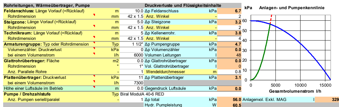
Abbildung 26 Modellparameter des Kreislaufs
