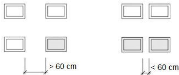
Abbildung 28: Relevante Fensterabstände mit Schwellenwerten hinsichtlich der Lüftungsverteilung
