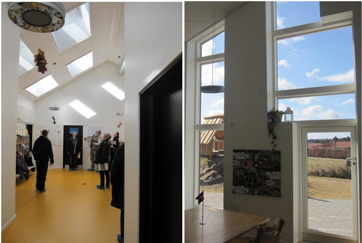
Abbildung 66: Kindergarten mit Tagesbetreuungszentrum Solhuset in Hørsholm, DK - Frischluftzufuhr mit automatischer Fensterlüftung und mechanischer Lüftungsanlage mit Wärmerückgewinnung
