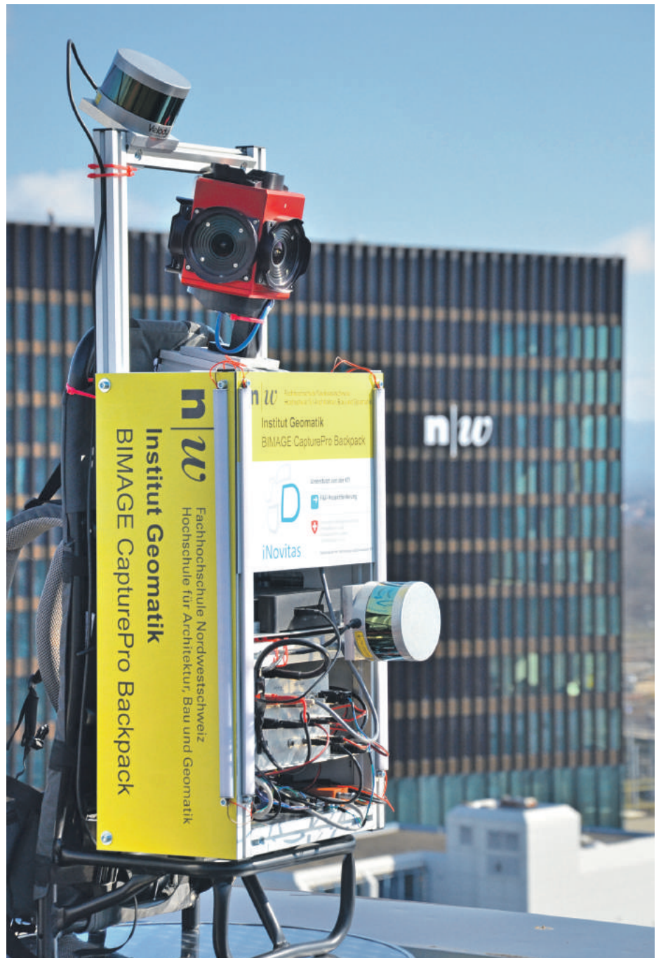
Der von der FHNW entwickelte «BIMAGE Backpack» ist ein Hightech-Rucksack zur Erzeugung virtueller 3D-Kopien von Gebäuden.
