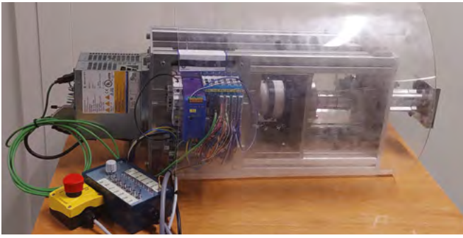
Abbildung 2: Prüfstand für Sensorelektronik und Energy Harvester
