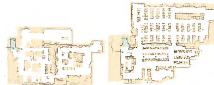
Abbildung 4: Online-Grafikkarte auf dem AMR, links das EG, rechts das UG. Hellbraun die ausgeschlossenen Fahrbereiche, die hellgrünen Bereiche sind die Liftkabinen, die dunkelgrünen Punkte AMR Ziele im Lift und im Wartebereich
