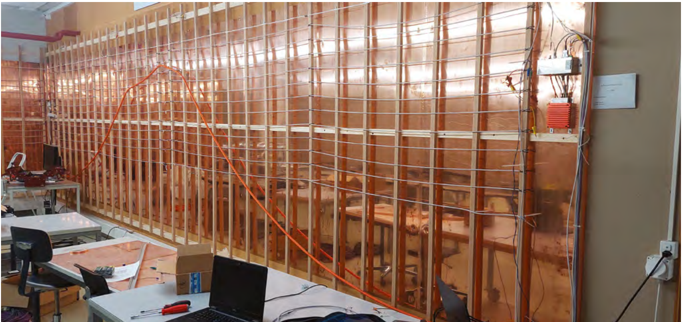
Abbildung 1: Verkabelungsnachbildung einer Avionik-Anwendung.
