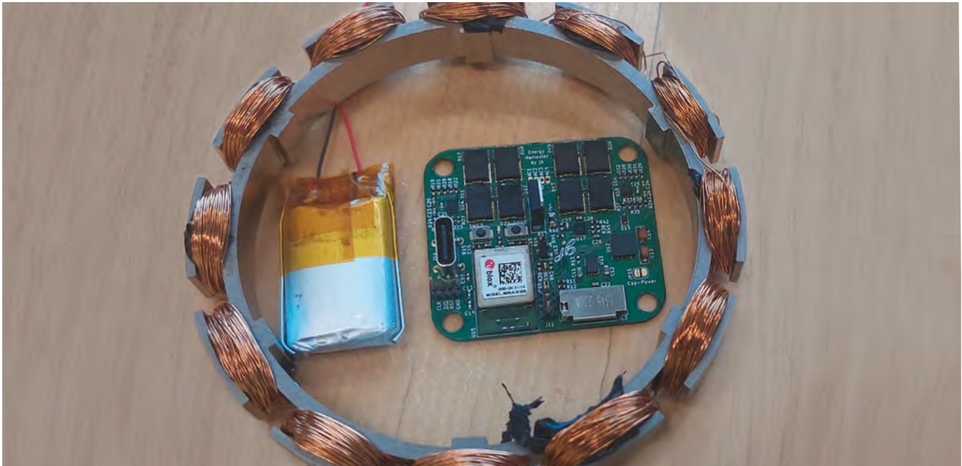
Abbildung 1: Harvester-Rotor mit bis zu 12 Wicklungen inklusive der Harvester Messelektronik
