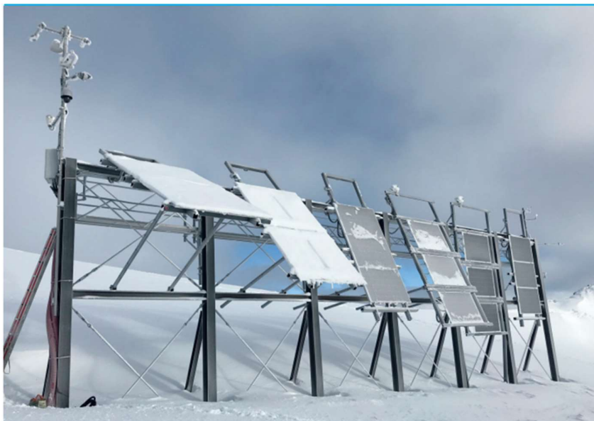
Bild 3: Testanlage für alpine PV zur Untersuchung der optimalen Neigung (vertikal), Projekt ZHAW in Davos-Talalp auf 2'500 m.ü.M, Quelle: VSE-Bulletin 10/2022
