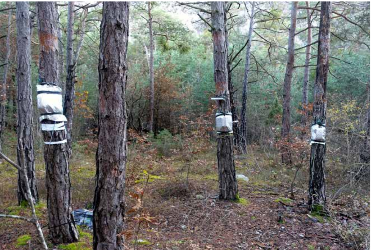
Forschungsplattform Pfynwald. Das Wachstum und das Funktionieren der Föhren wird mittels verschiedener Sensoren im Minutentakt untersucht, z.B. Jahrringwachstum, Saftfluss, Bodenfeuchtigkeit, -temperatur, -atmung, Photo-
