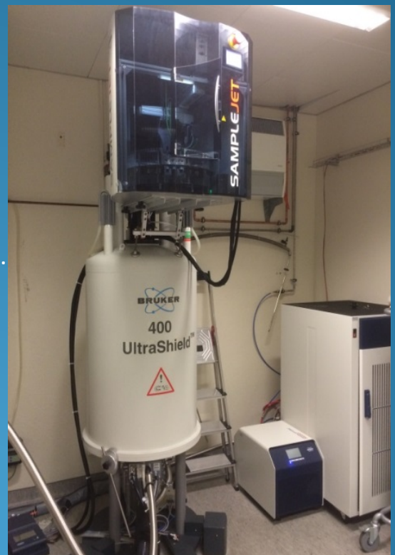
Abb. 4 Unser 400 MHz-NMR mit Prodigy-Probenkopf und Sample Jet mit Platz für über 500 Proben
