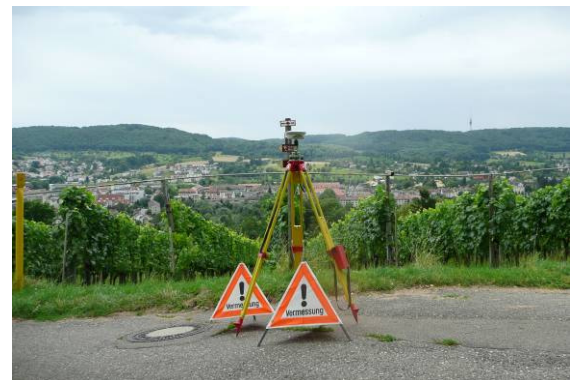
Abb 2 langstatische GNSS Messung
