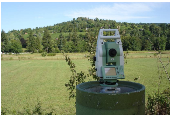
Abb 1 Messpfeiler, im Hintergrund das Rutschgebiet "Schlipf"
