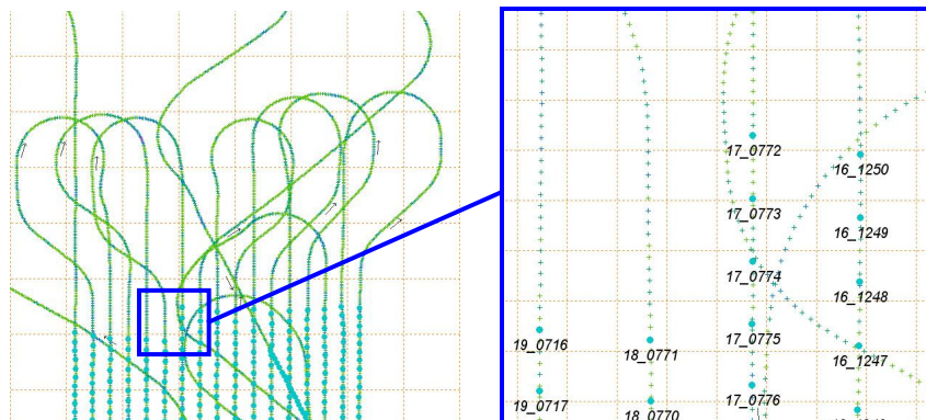
Abb. 2: Ausgewertete Flugtrajektorien mit Bildaufnahme-Positionen in Inertial Explorer
