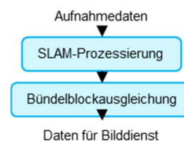
Abb. 2: Ablaufschema der BIMAGE Datenauswertung
