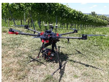
Abb. 1: links: UAV DJI Matrice 600 Pro mit Headwall, mitte: Bildwürfel mit den 3 Dimensionen, rechts: Beispielplot Signatur der Pixelwerte
