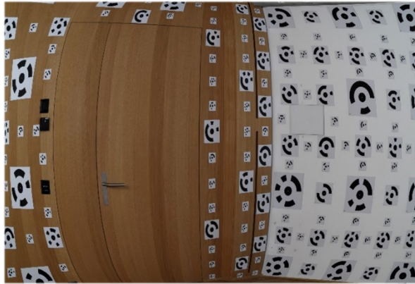
Abb. 20: Bildaufnahme äquidistante Projektion
