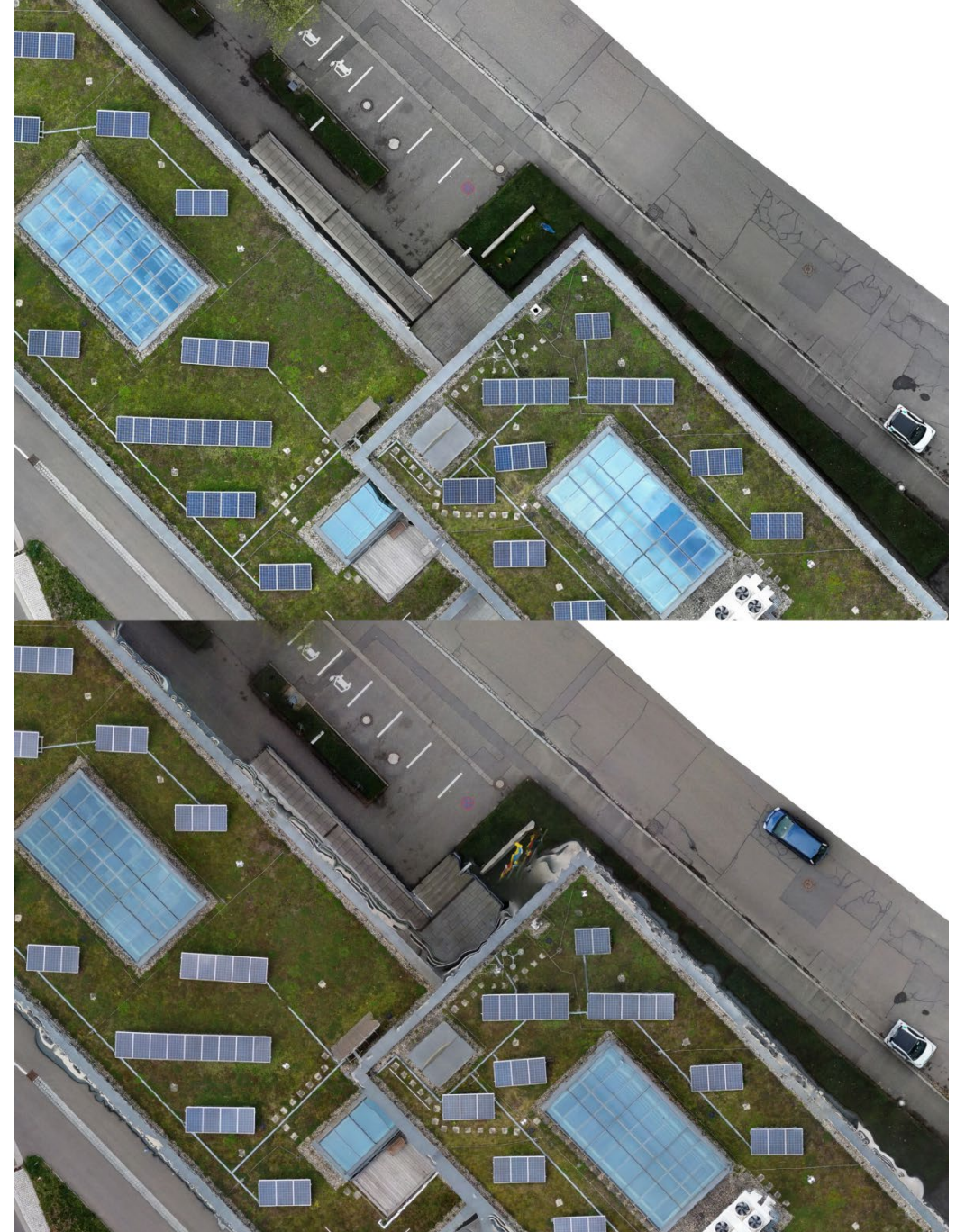
Abb. 10: oben – Orthophotoausschnitt des 80m-Fluges mit der DJI Mavic 3E, unten – Orthophotoausschnitt des 60m-Fluges mit der DJI Mini 2
