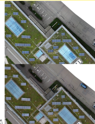
Abb. 10: oben – Orthophotoausschnitt des 90m-Fluges mit der DJI Mavic 3E, unten – Orthophotoausschnitt des 90m-Fluges mit der DJI Mini 2
