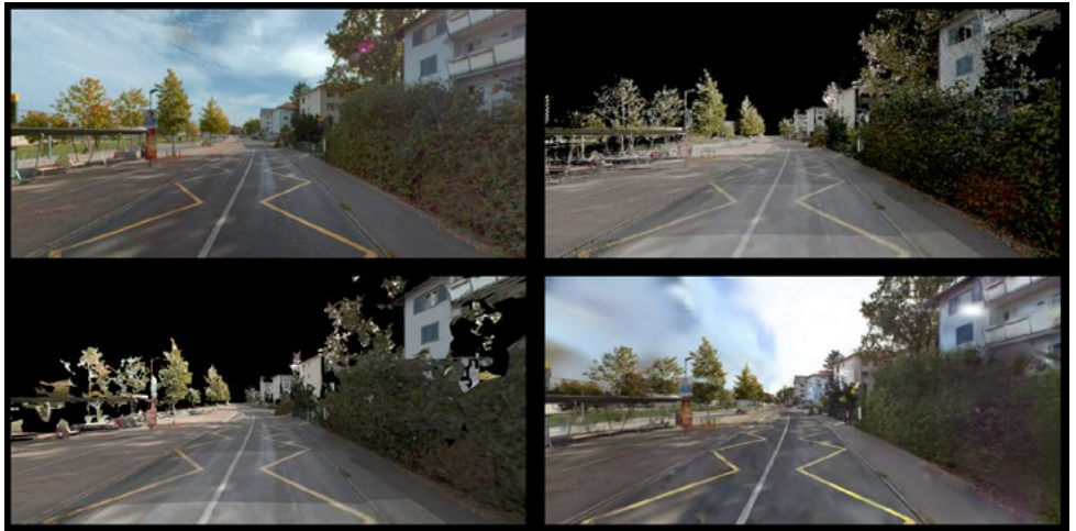
Abbildung: Verschiedene Objekt-Repräsentationen von dem gleichen Standort. Von oben links nach unten rechts: Originalbild, Punktwolke, Mesh und Gaussian Splat (aus Mth A. Eisenring)
