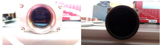
Abb. 3 & 4: Kamera Frontansicht ohne Optik mit direkter Sicht auf die Chipoberfläche (links) und mit Grauwertfilter ND1000 (rechts)
