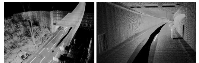
Abb. 4: Kinematisch ermittelte Punktwolke des Elbtunnels
