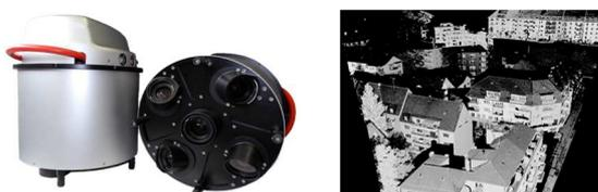
Abb. 1 - links: Luftbildkamera Leica RCD30 Oblique Penta, rechts: Ausschnitt eines Referenzdatensatzes (terrestrisches Laserscanning)
