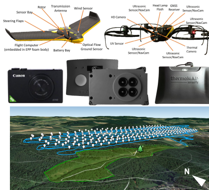
Abb. 1: Oben: Eingesetzte senseFly-Fluggeräte - links „eBee“, rechts „Albris“. Mitte (v.l.n.r.): eBee-Infrarot-sensoren – Canon S110 NIR, Airinov MultiSpec4C, senseFly Thermomap. Unten: Typische Flugbahn mit der eBee (blau) über einem Tierpark (grün) mit den Auslösepositionen für Luftbilder (weiss). (Gillins et al., 2018; Google 2018; senseFly 2018)
