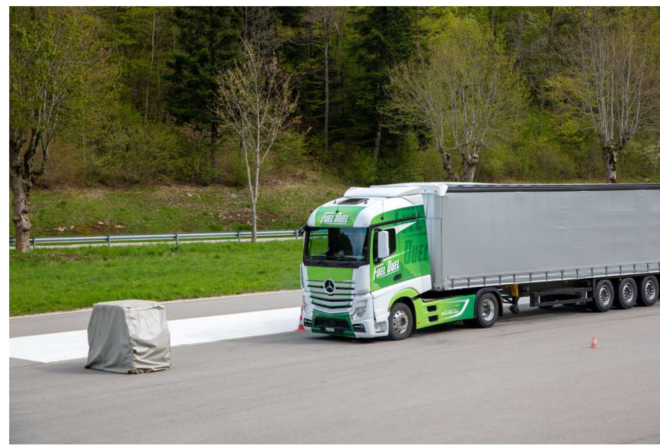
Abb. 1: Vorführung Notbremsassistent mit 89 km/h (eigene Aufnahme)
