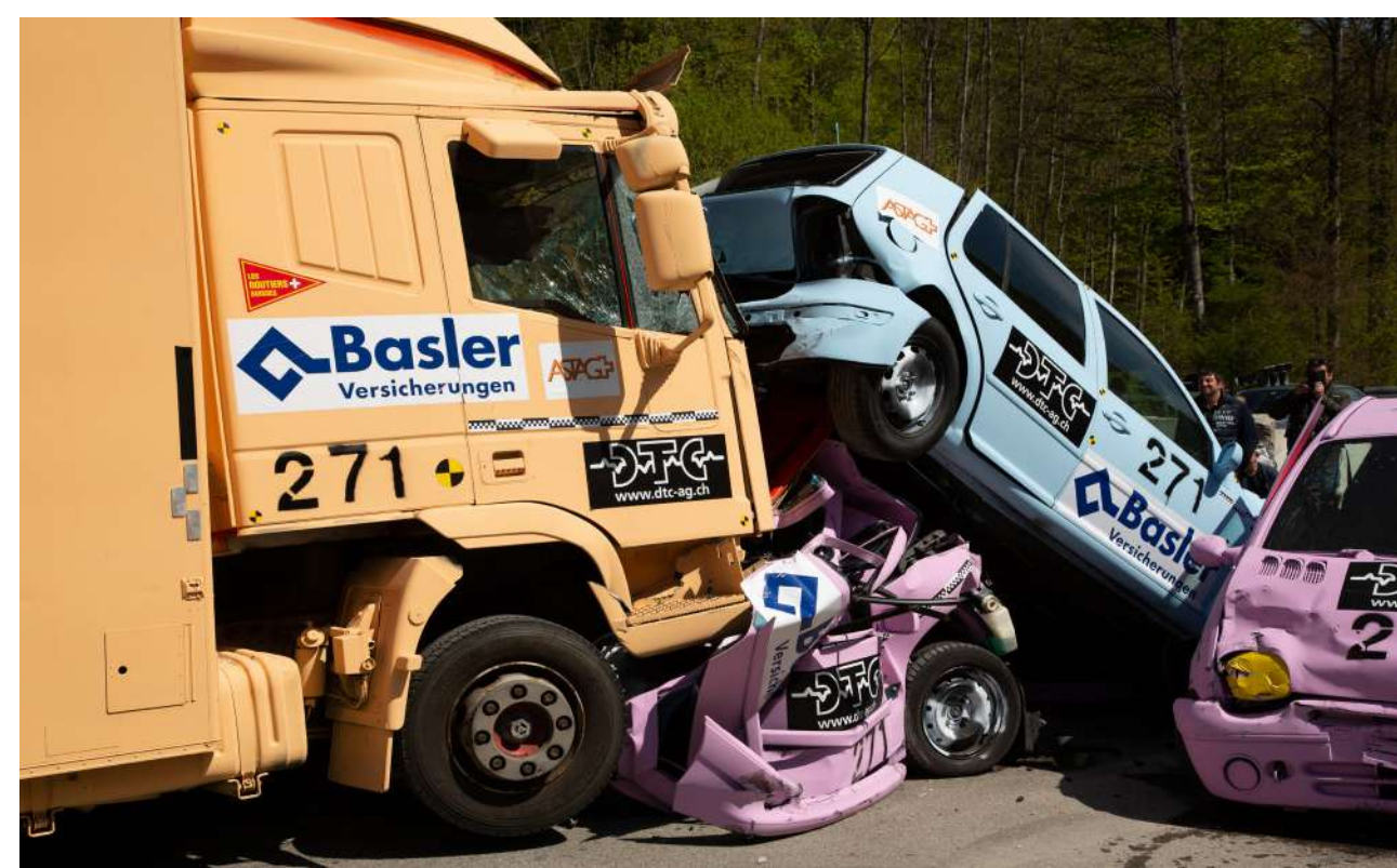
Abb. 3: Crashtest ungebremsst mit 80 km/h (eigene Aufnahme)
