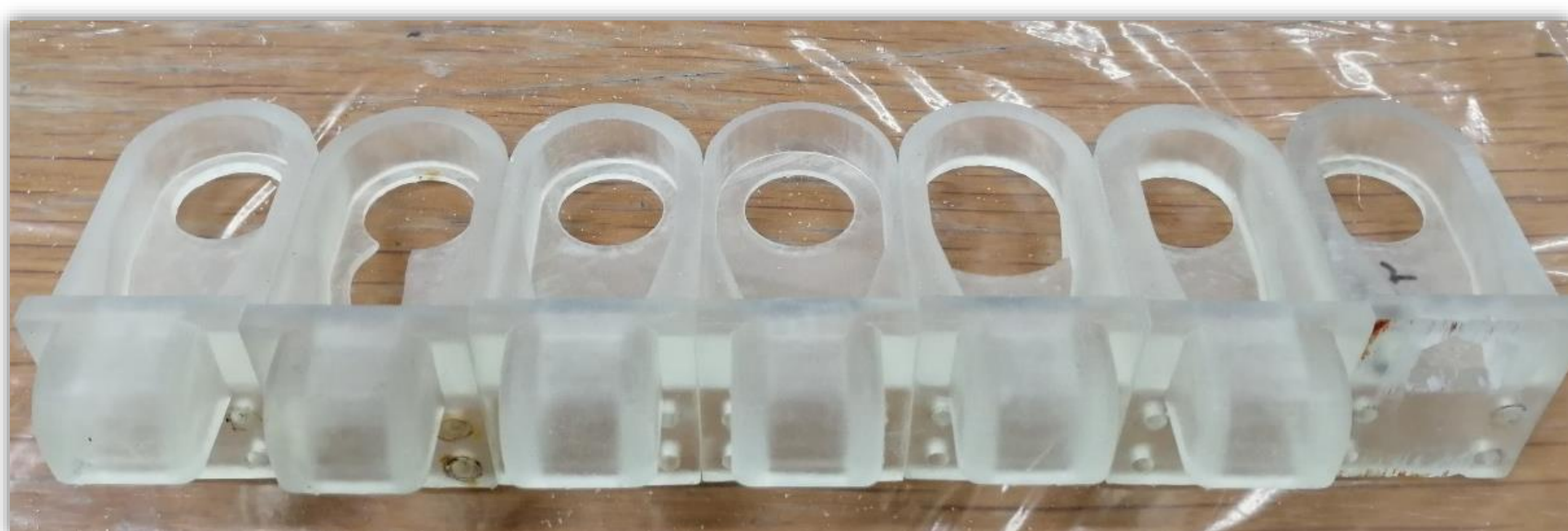
Hergestellter Testkörper bestehend aus Körper, Deckel, Zylinder und Modul mit verschiedenen Modulversionen
