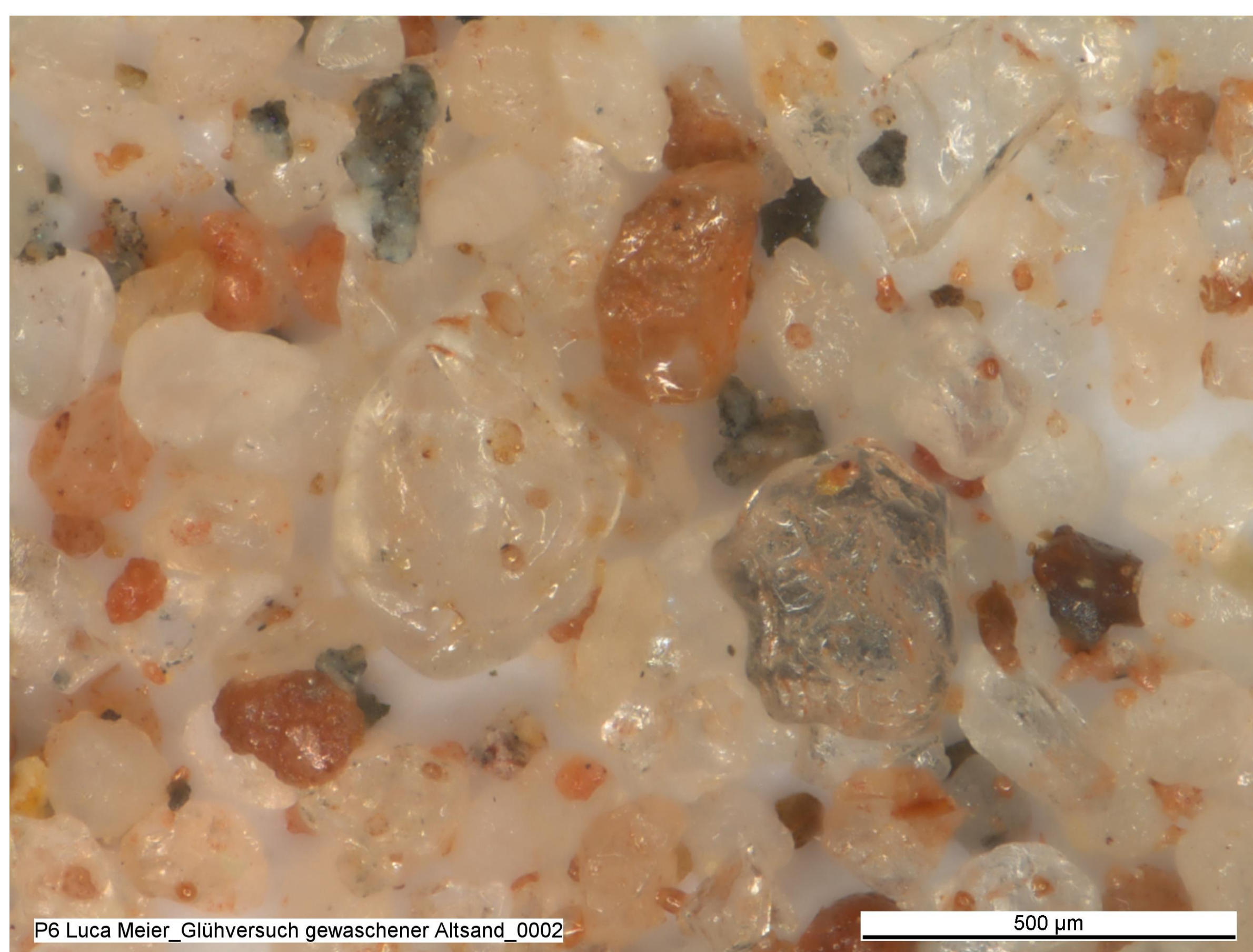
Abbildung 2 Aufnahme von Giessereisand mit und ohne Schamotthülle
