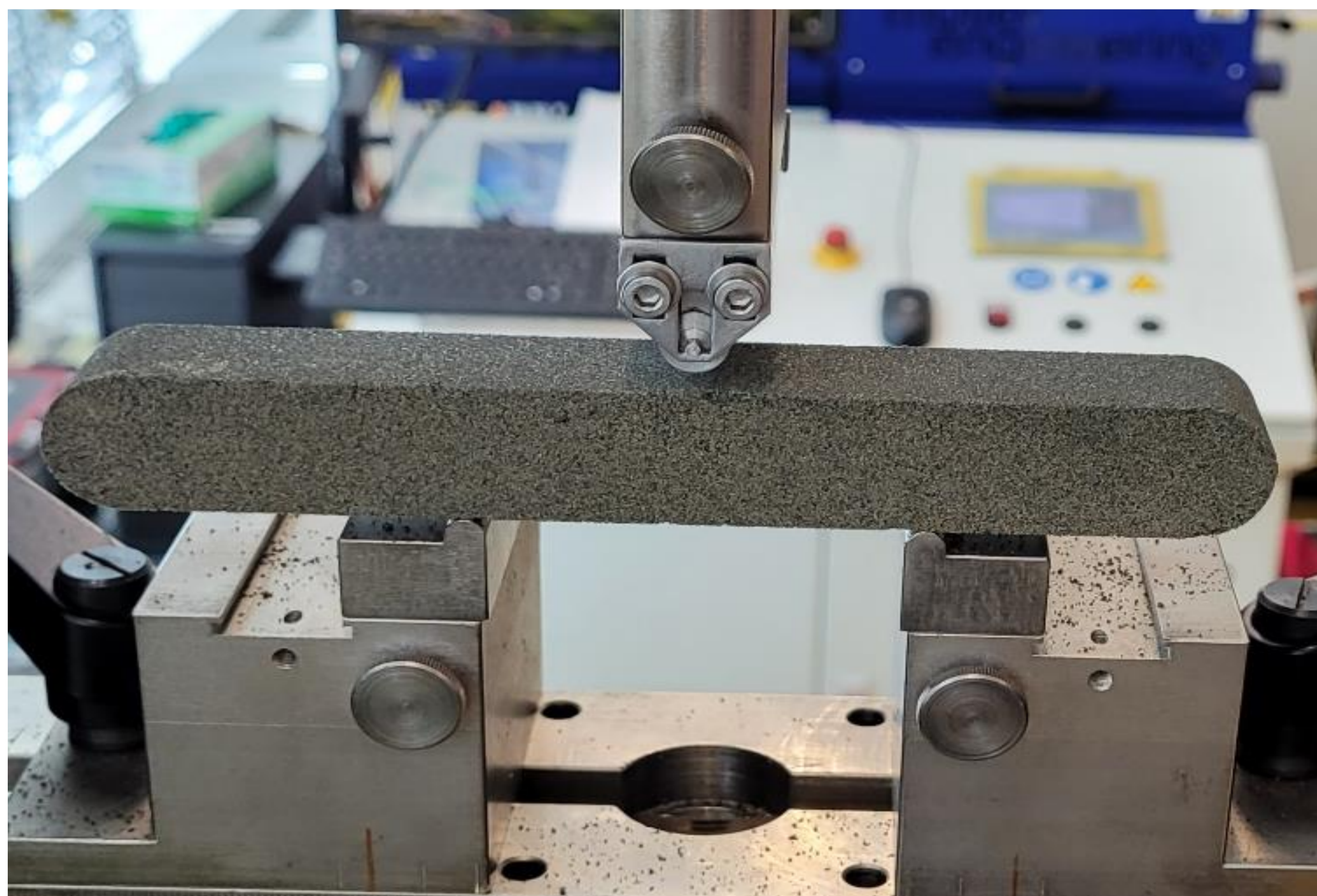
Abbildung 1 Foto einer Biegeprobenprüfung von Furanharz-gebundenem Neusand
