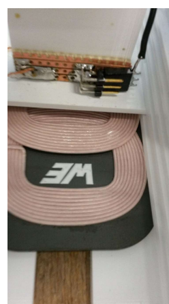
Abb. 4: Sendespulenarray im Testaufbau. Die Empfängerspule darüber ist verdeckt.
