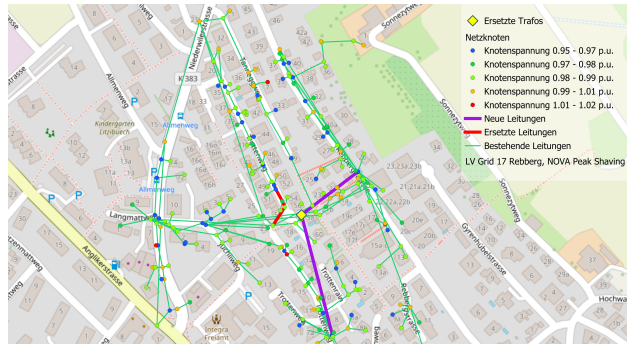
Ausbaumassnahmen des Niederspannungsnetzes mit aktivem Peak Shaving
