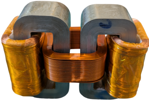
Variable Induktivität mit DC-Bias
