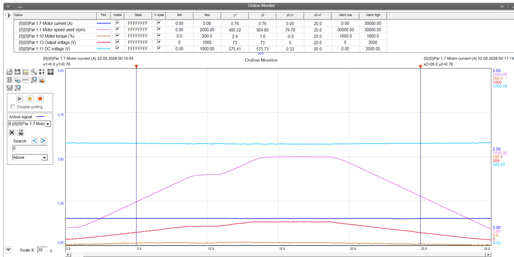
Benutzeroberfläche zur Überwachung und Bedienung im Drive Composer
