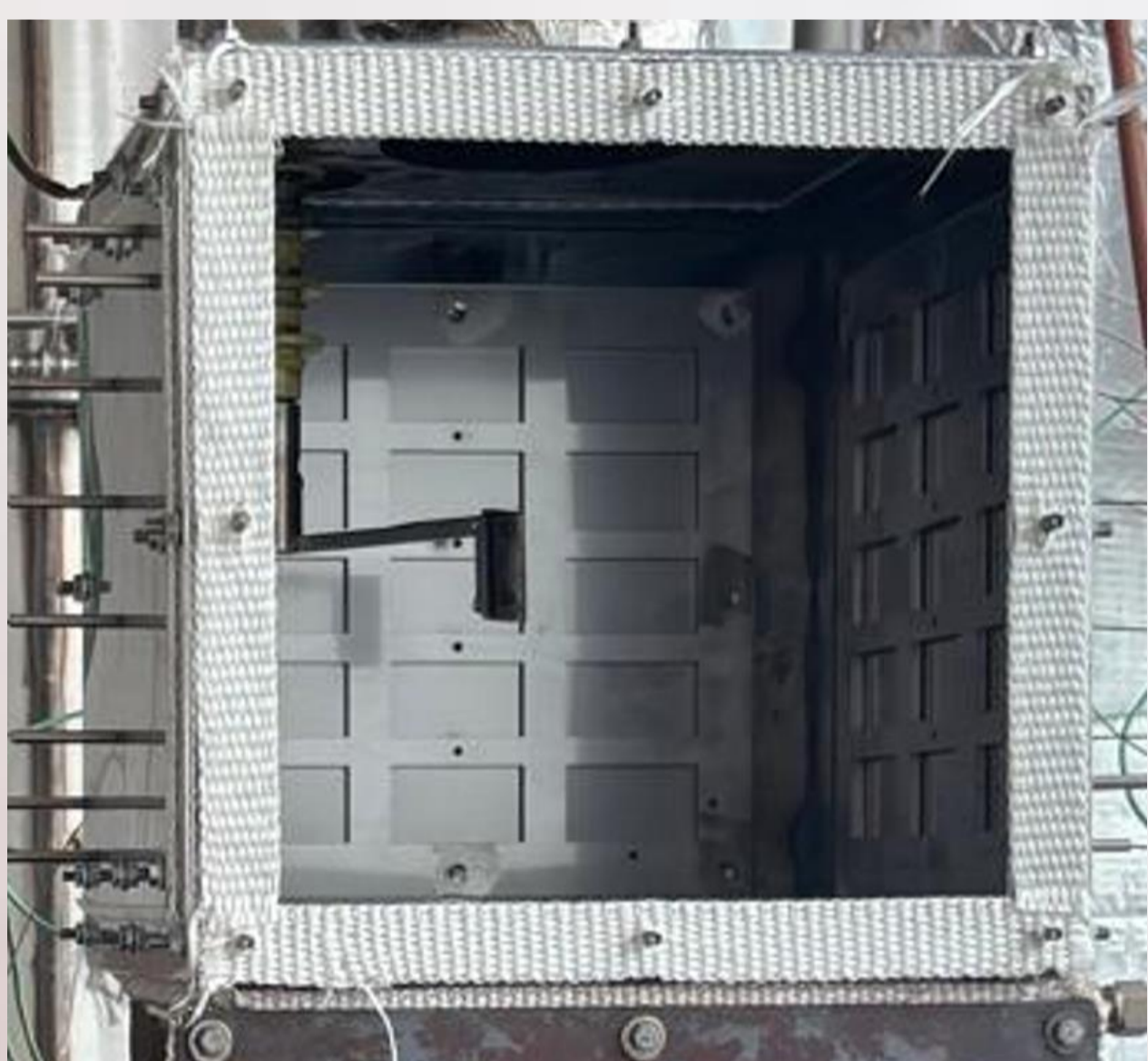
Abscheiderbox mit elektrostatischem Partikelabscheider
