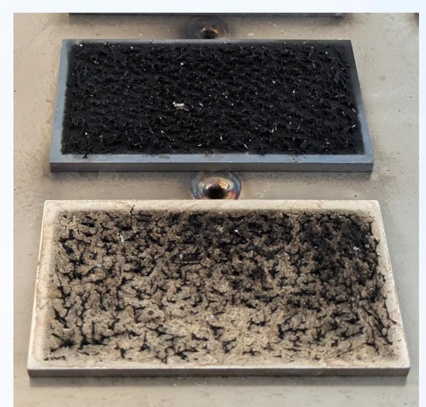
Vergleich eines Katalysators mit einer Edelstahlplatte
