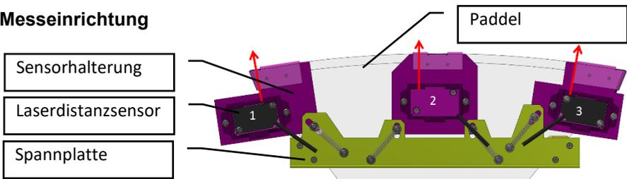
Die Messeinrichtung misst mittels Laserdistanzsensoren die Distanz des Paddels zur Trommelwand. Sensorhalterungen fixieren die Lidar an Ort und Stelle. Durch die Spannplatte werden die Anschläge der Sensorhalterungen an die Paddelkanten gezogen, so dass sich die Sensoren in keiner Paddelstellung bewegen. Das Herzstück ist ein Arduino der die Messwerte
