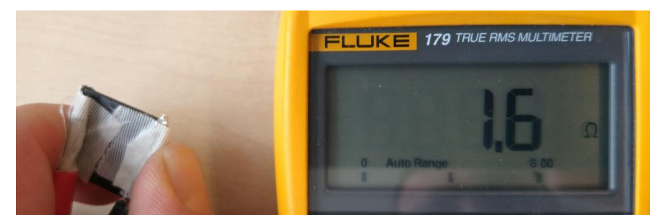
Ermittlung des Widerstand der Testplättchen für die Anbindungsversuche
