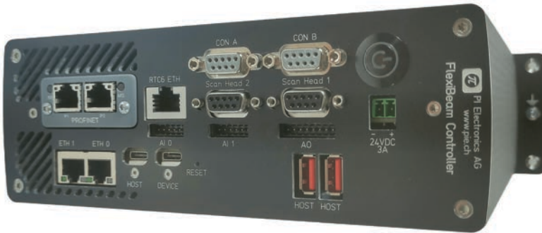
Selbstentwickelter Real-time Controller
