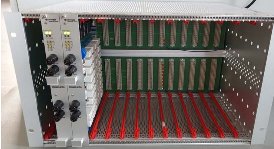
Umschaltmatrix mit zwei Relais-Karten im 19-Zoll-Baugruppenträger
