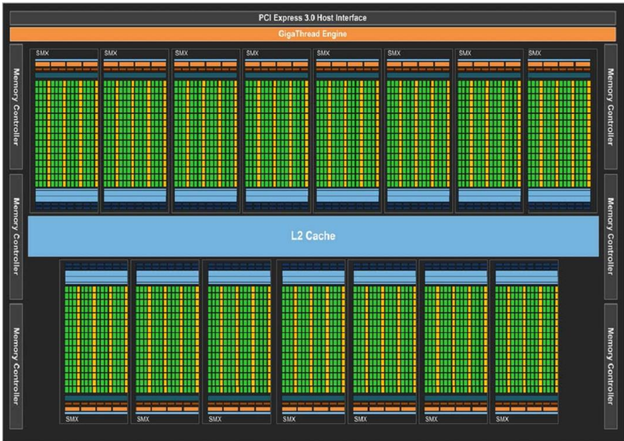
Abbildung B.4: Gesamtübersicht über einen nVidia Chip mit Kepler Architektur. Bild aus [3].
