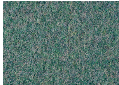
1 Tissus doubles avec 4 systèmes de fil, endroit du tissu
