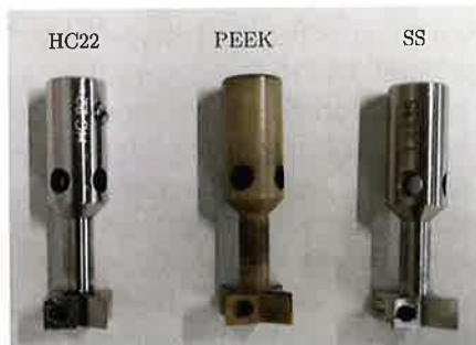
Abbildung 3: Die drei im Explosionsreaktor verwendeten Rührer, die aus Hastelloy C22, PEEK und Stahl rostfrei angefertigt wurden. Durch das Verwenden eines jeweiligen Rührers kann ein Rückschluss auf die Oberflächenkatalyse des Materials bezüglich der Hydroxylamin-Zersetzung gemacht werden.
