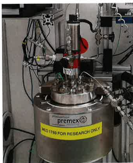
Abbildung 2: Explosionsreaktor zur Druckmessung der Hydroxylamin-Zersetzung bei isoperibolen Bedingungen.
