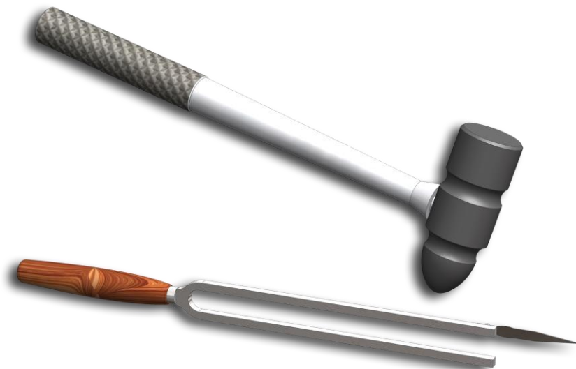
Abb. 6: Die Stimmgabel mit der Metallfeder wird mit einem Hämmerchen angeschlagen (©Schumann)
