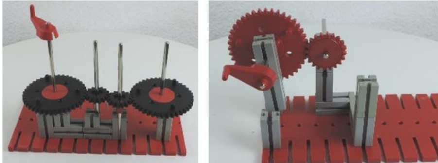
Abb. 8: Über- und Untersetzungen mit Zahnrädern (©fischertechnik)
