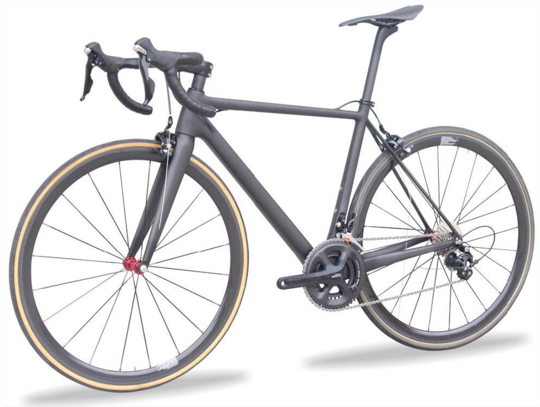
Abb. 23: Rennrad mit Fahrradrahmen aus CFK, Gesamtgewicht 7.2kg; Gewicht Rahmen = 850g
