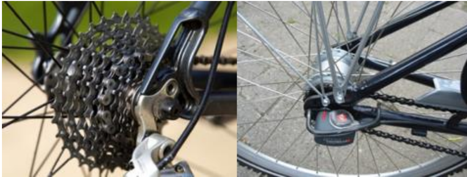
Abb. 13: Links: Kassette am Hinterrad bei einer Kettenschaltung; rechts: Hinterrad mit Nabenschaltung
