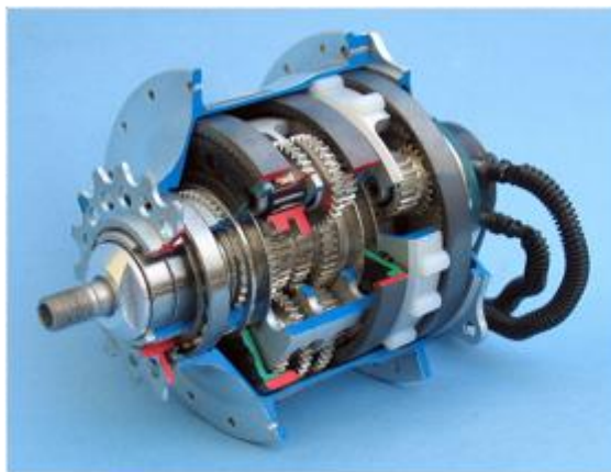
Abb. 14: Links: Planetengetriebe einer 14-Gang-Nabe (Rohloff Speedhub 500/14); rechts: Schnittmodell einer Sturmey-Archer Nabe
