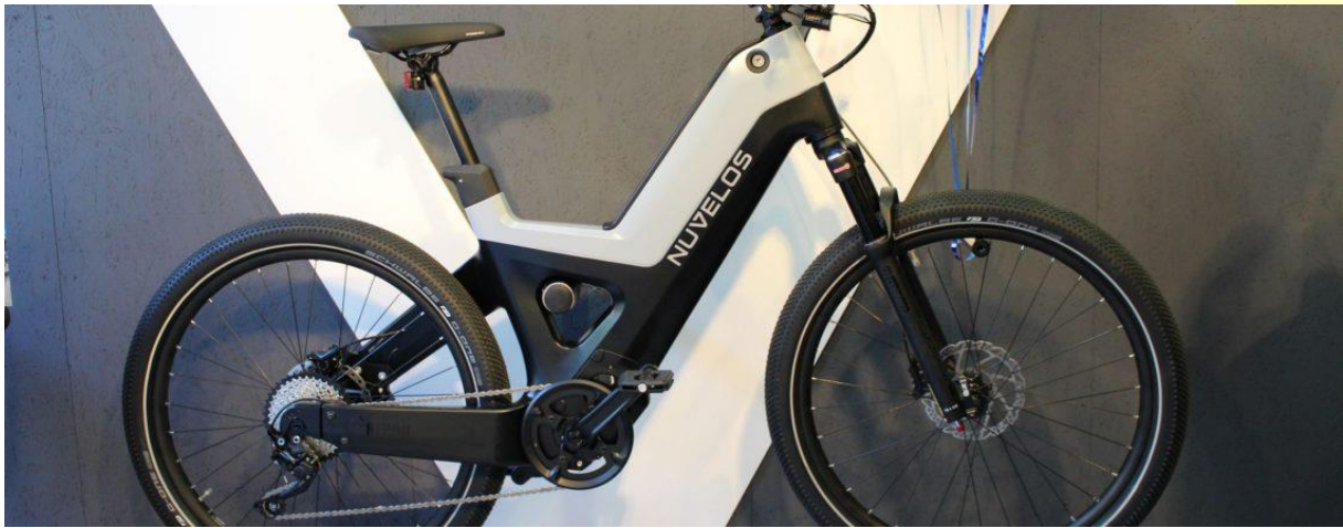
Abb. 25: E-Bike der Fa. Nuvelos aus spritzgegossenen Kurzglasfaserverstärkten Kunststoffen; Quelle K-Zeitung/Kögel
