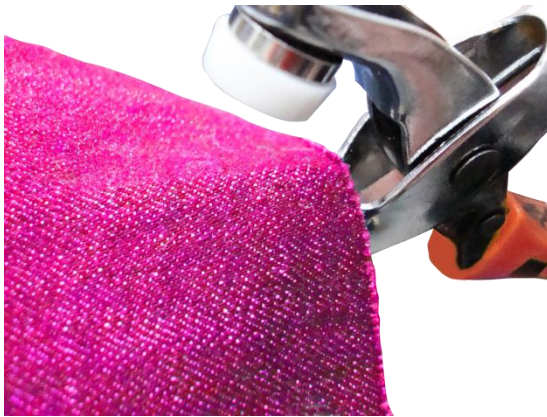
Abb. 35: Anbringen eines Druckknopfs mit Druckknopfzange
