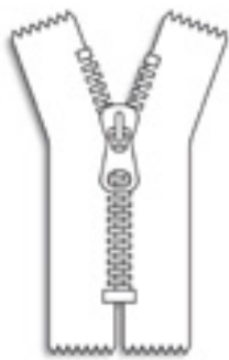
Abb. 49: Reissverschluss: nicht teilbar, unten aushakbar
