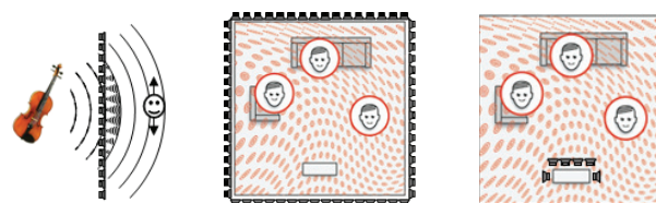
Bild 2: a) Erzeugung Wellenfeld b) Wellenfeld-Erzeugung durch aussenliegende Lautsprecher c) Umkehrung: Lautsprecher-Array innerhalb Hörzone
