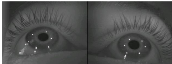
Abbildung 1: Messprinzip der SMI-Gazeware, Cornea-Reflex-Methode
