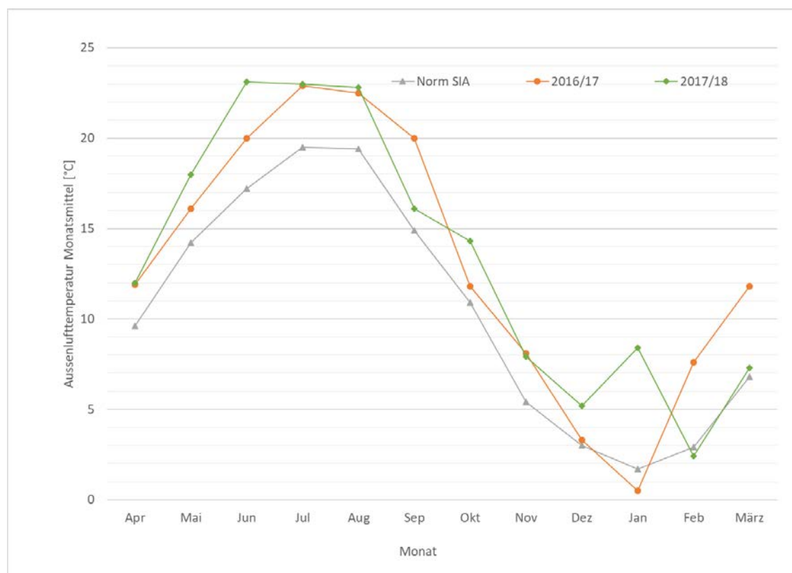
Abbildung 3: Langjähriges Monatsmittel der Aussenlufttemperatur Klimastation Basel-Binningen gemäss Norm SIA 2028 und Monatsmittel der Messwerte 2016/17 und 2017/18 am Standort Aescherstrasse 12 Basel.
