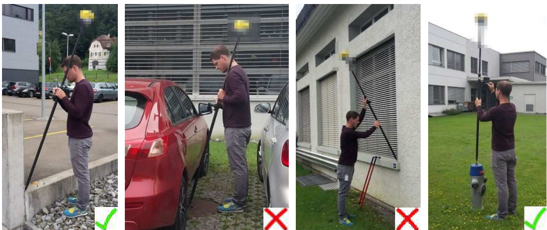
Abb. 3: Neue Messmöglichkeiten durch die Neigungskompensation
