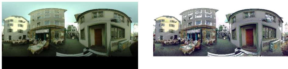
Abbildung 1: Vom Originalbild zum fertigen Bild mit Belichtungsoptimierung, Weissabgleich und Segmentierung des Himmels (Bildquelle: IGEO FHNW)
