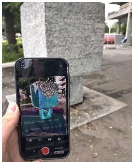
Abbildung 1: Der LiDAR-Scanner des iPhone 12 Pro in Aktion
