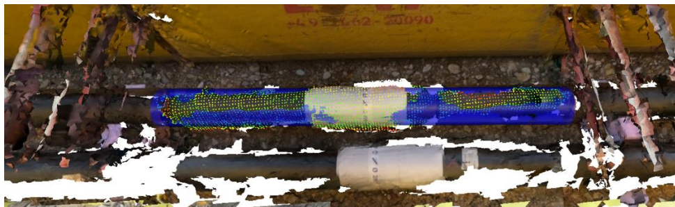
Abbildung 3: Scan einer Leitung mit reingefittetem Zylinder (blau)
