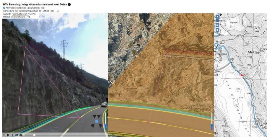
Abb. 2: Messung eines Punktes, welcher im Strassenbild nicht erkennbar ist
