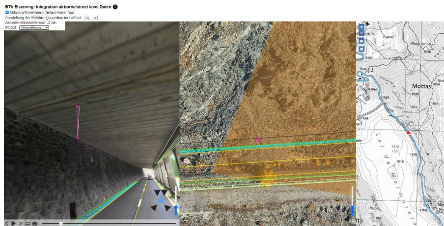
Abb. 3: Höhe des Schuttkegels auf einer Galerie bestimmen
