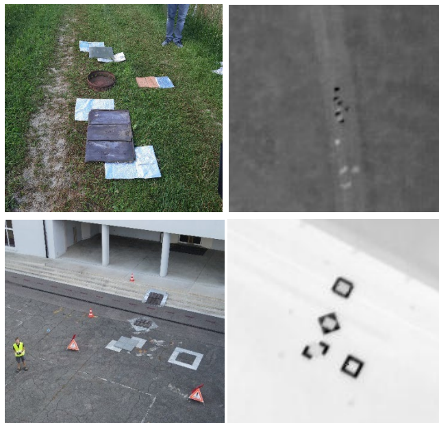
Abb. 1: Referenzmaterialen Standort Langenthal (oben) und Muttenz (unten) – RGB-Bilder links und Thermalbild DuetT rechts
