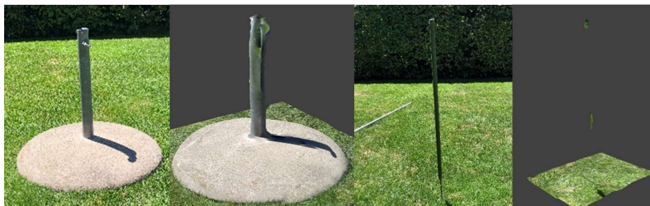
Abbildung 1: Versuch zur Bestimmung der minimalen Dicke von Aufnahmeobjekten. Links Schirmständer Ø 3 cm, rechts Rankenstab Ø 2 cm
