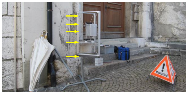
Abb. 2: Bestimmung des Schweregradienten des LSN2004-Punktes «Aarburg» auf fünf Höhenstufen (gelb markiert)
