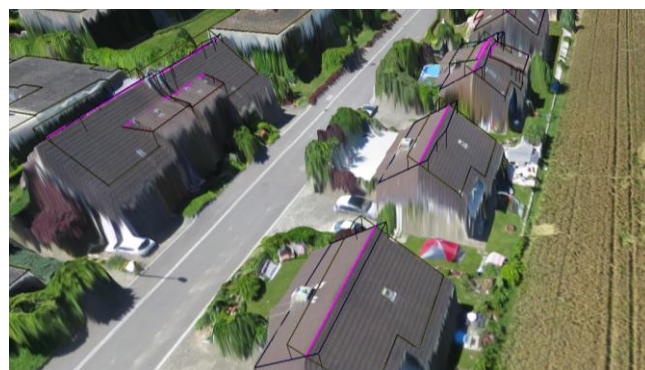
Abb. 3: Extrahierte Dachkanten und noch nicht gestutzte Dachflächen bei texturiertem Oberflächenmodell
